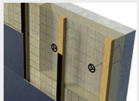
Thermisch geoptimaliseerde bevestigingswijze met afstandschoeven
