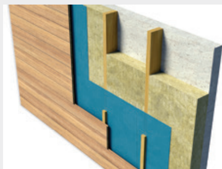
Traditioneel bevestigingssysteem met isolatie tussen houten regelwerk
