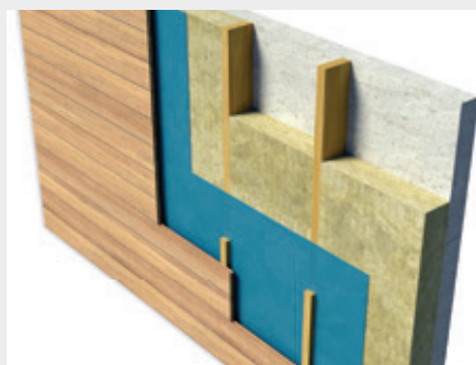
Système de fixation traditionnel avec isolation entre des linteaux en bois
